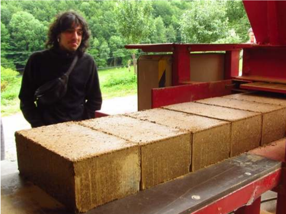
Presse à BTC auto-construite en Ariège - Aurélien Bielsa © photos : Association Écorce
